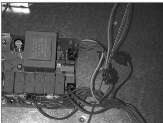
Figure 4: Détail de la connexion à la prise J3 de l'interface LCD
