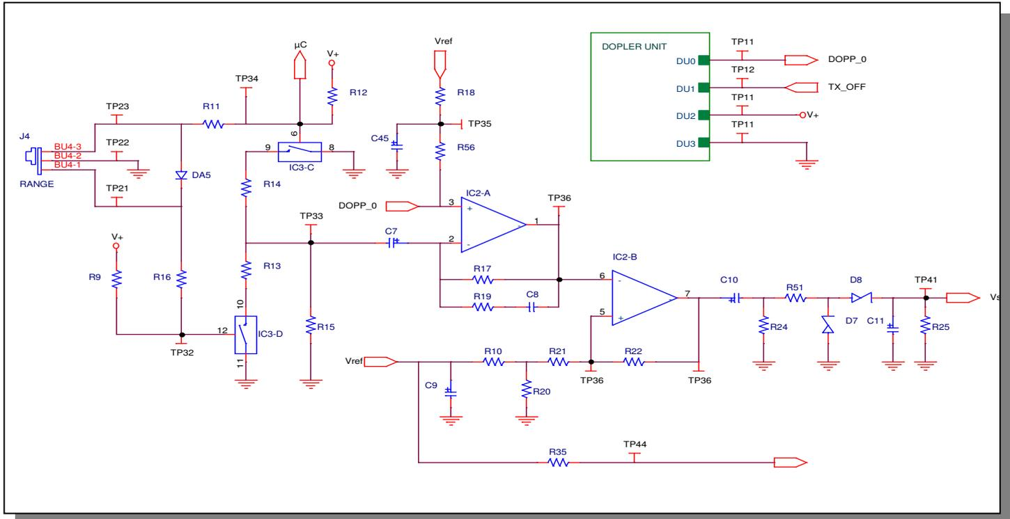
Le rapport d'amplification qui détermine la portée du détecteur est liée à la boucle de contre réaction de l'étage amplificateur construit autour de IC2-A, comportant les résistances R13, R14 et R15. Compléter le tableau ci-dessous en déterminant, à partir de la position du cavalier J4 :
