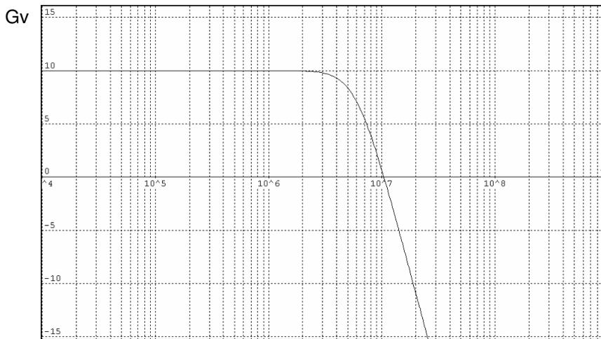
3.3.4. Déterminez graphiquement la fréquence de coupure  $F_c$  du filtre
