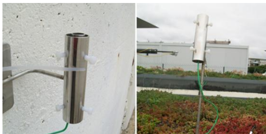
Figure 5. Tube basse émissivité de protection pour thermocouples air
