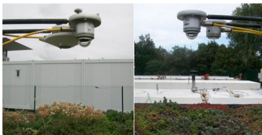
Figure 6. CMP3 et CGR3 pour les mesures des flux radiatifs CLO réfléchis et GLO émis.
