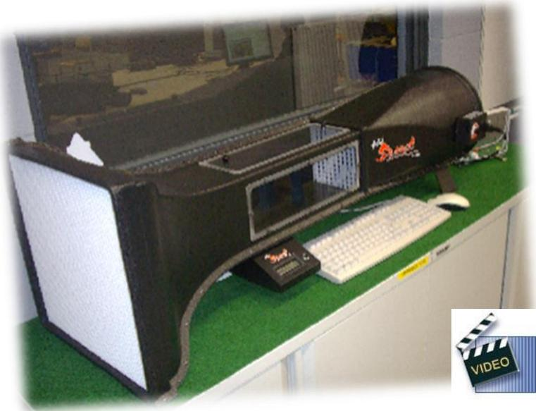
Une soufflerie nous permet de mesurer la force de traînée en fonction de la vitesse.
