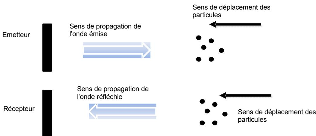
Les particules renvoient une partie de l'onde acoustique vers le transducteur ultrasonore. Celui-ci fonctionne tantôt en émetteur et tantôt en récepteur. Les ondes acoustiques sont des ondes longitudinales.
