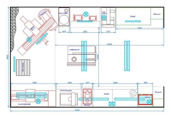
Les éclairages fluorescents sont représentés par des rectangles bleus. Les autres lampes, représentées par des ronds et carrés avec une croix, sont des halogènes 35 W.
